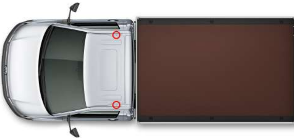
Fig. 3 : points de fixation de série sur le pavillon du Pick-up
