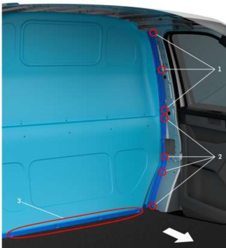
Fig. 2 : points de fixation de la cloison de série – vue de la cabine conducteur à gauche (la flèche indique le sens de la marche !)
