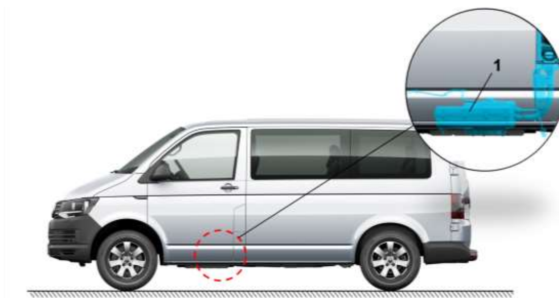
Fig. 1 Position de montage du réservoir d'AdBlue dans le véhicule
