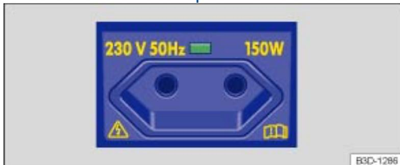
**Fig. 52** Prise de courant européenne 230 volts.
