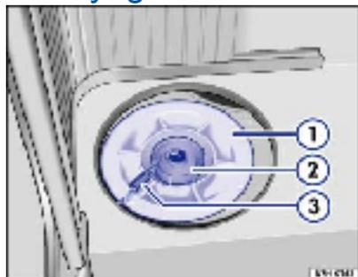
**Fig. 65** À l'arrière de la lingerie, sous le plateau : regard de nettoyage du réservoir d'eau propre
