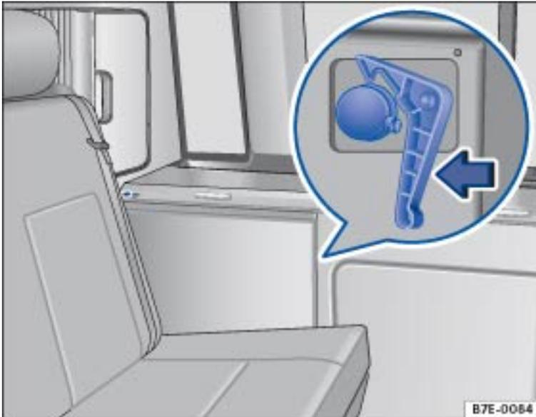
**Fig. 45** Dans le séjour : table de travail en position de base et levier de déverrouillage (agrandissement)
