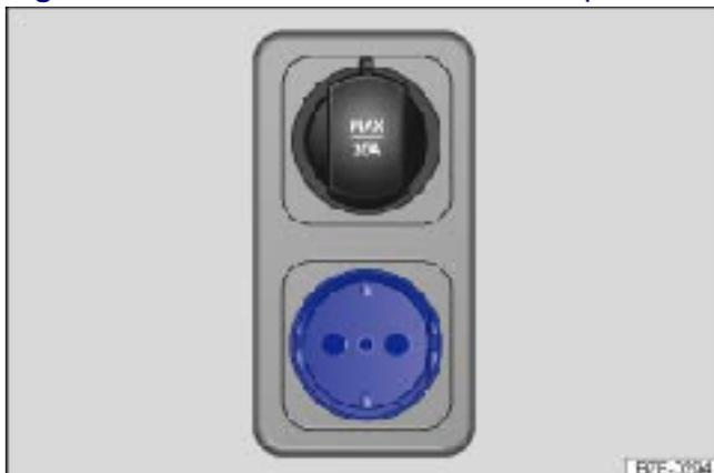
**Fig. 55** Sur le côté, derrière le siège avant gauche : prise de courant de sécurité 230 volts
