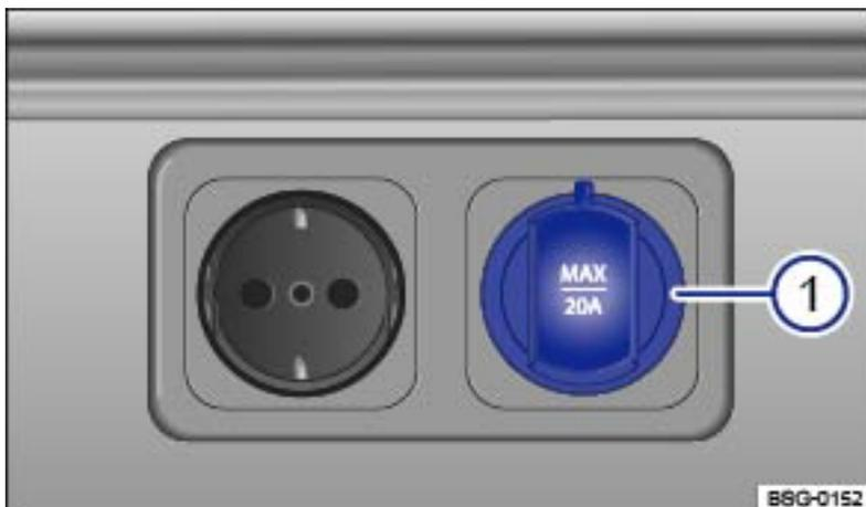
**Fig. 50** Sur le côté du bloc-cuisine : prise de courant 12 volts ①.
