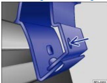
**Fig. 41** Dans le support de marquise : vis (flèche)
