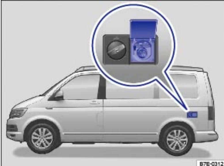
**Fig. 51** Prise de courant extérieure 230 volts
