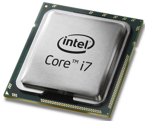
Un microprocesseur multi-cœur réunit plusieurs circuits intégrés de processeur dans un seul boîtier.
